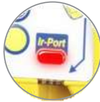
Infrarot-Abrechnungssystem nach EVA/DTS-Standard
